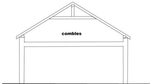
Superstructure d'un bâtiment, comprenant la charpente et sa couverture ; par extension, volume entre le plancher haut et la toiture d'un bâtiment.
