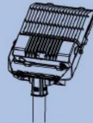
MONTAGE SUR POTEAU
